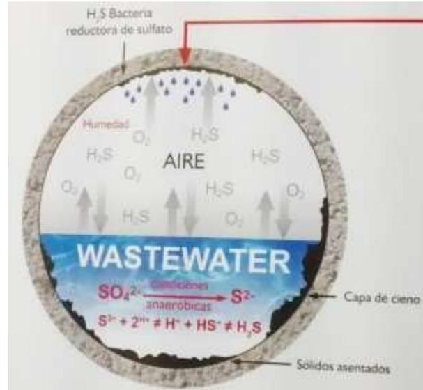
Las bacterias entonces transforman los compuestos de sulfuro en ácido sulfúrico, que ataca el concreto por corrosión ácida y, a largo plazo, en ataque por expansión de sulfatos. Finalmente, el concreto se corroe lentamente auto destruyéndose.
